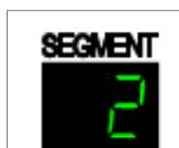
Η οθόνη ένδειξης βήματος (μικρή οθόνη) μας δείχνει τον αριθμό του βήματος στο οποίο βρίσκεται το καμίνι, ενώ στην οθόνη ένδειξης σταδίου μας δείχνει το στάδιο στο οποίο βρίσκεται το καμίνι.
